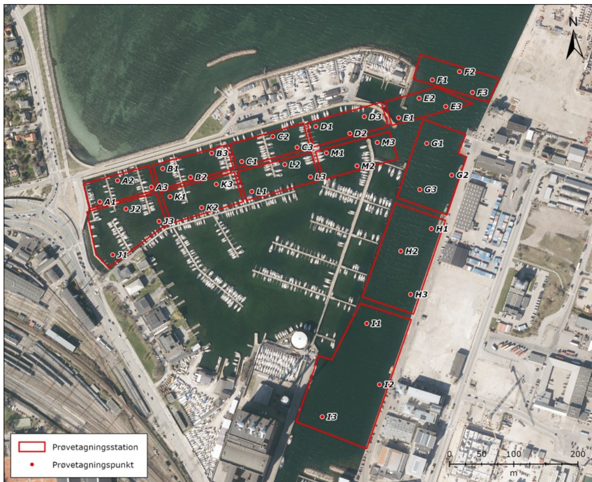
Figur 3-1. Områderne A – I hvor der er udført miljøundersøgelser og hvor der fra område A – G vil blive foretaget uddybning/opgravning af sediment og intakt havbund for den planlagte Nordhavnstunnel, hvoraf andel af opgravet materiale på 50.000 m 3 ansøges klappet på klapplads K_046_03.
