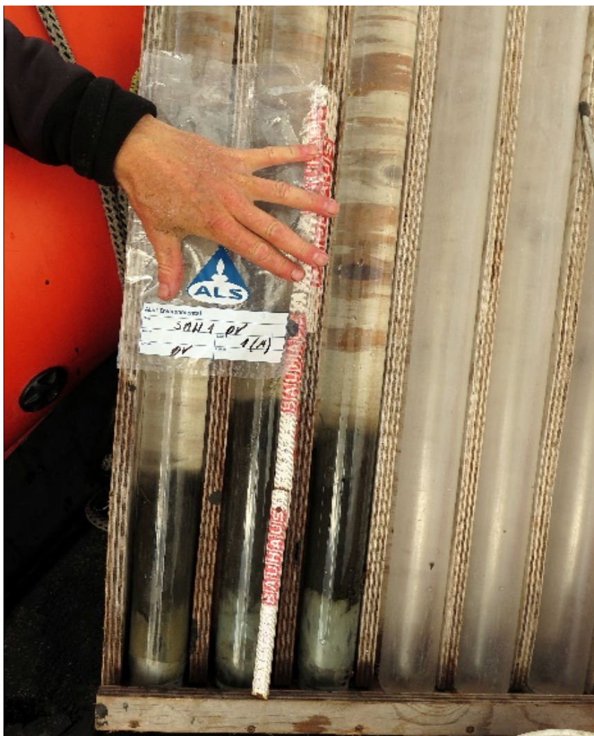
Figur 6-2. Eksempel på overfladesedimentet fra Svanemøllehavn, 6. okt. 2020, med intakte prøver udtaget med kajakrør. Den oprindelige havbund kan genkendes som det lyse lerlag under det sortfarvede overfladelag /9/.
