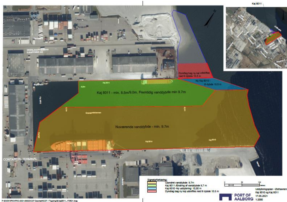
Figur 1. Uddybningsplan – Østhavn. Dyndlag (rødt område) bag ny kaj 8010 udskiftes ned til kote -10,5 m DVR90, foran kaj 8010 (blåt område) uddybes til kote -10,5 m DVR90, foran 8011 uddybes til kote -9,7 m DVR90 (grønt område), mens det gule område forbliver uændret.
