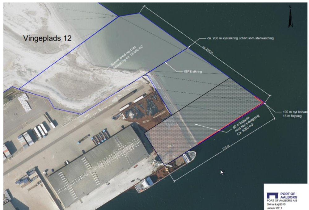
Figur 2. Oversigt af anlægsprojektet, som omfatter etablering af kaj 8010 og forlængelse af eksisterende stenkastning (se også Bilag 4).
