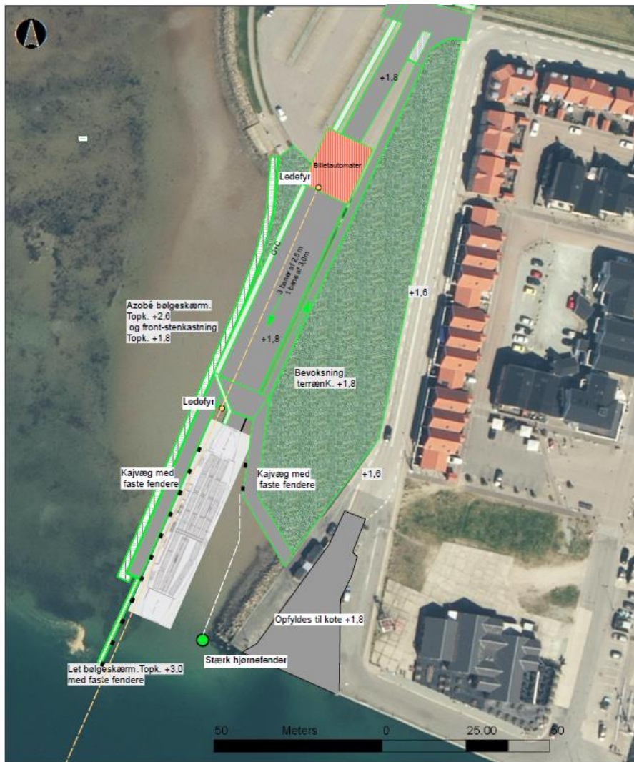
Figur 1 Forslag til skitse af projektet, der inkluderer ombygning af færgelejerne ved Hals færgehavn. Det viste opfyldsområde af eksisterende færgeleje (gråt) er dog kun en mulighed, som endnu ikke er afgjort, og som derfor ikke er en del af det ansøgte projekt. Ladestander til færgen placeres forventeligt på vestsiden af det nye færgeleje jf. designspecifikationer fra færgeleverandøren.
