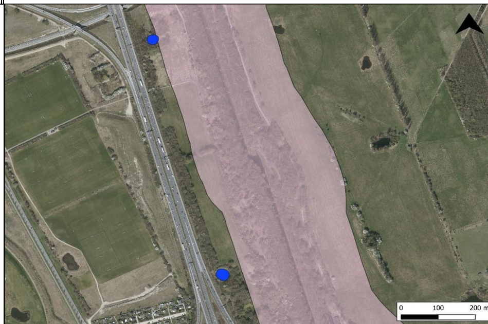
Figur 3.3: Det nordlige regnvandsbassin ligger delvist inden for fortidsminde beskyttelseslinjen. En udvidelse af det eksisterende bassin kræver derfor en dispensation. Det sydlige regnvandsbassin ligger uden for fortidsmindebeskyttelseslinjen.
