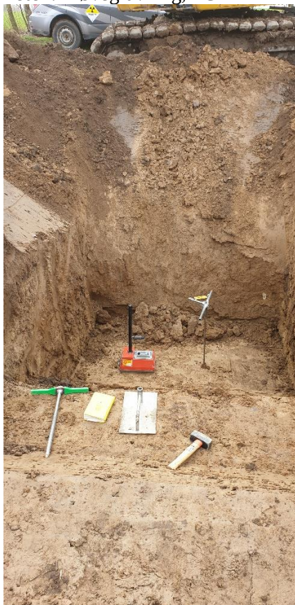
Foto 2: PG2. Isotopmåling 2,0 m u.t. og vingeforsøg 2,4 m u.t.
