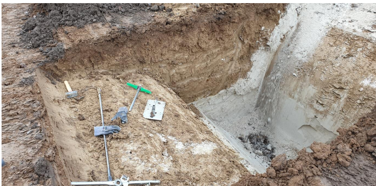
Foto 4: Prøvegravning PG4, Hvidt Smeltevandssand under moræneler.
