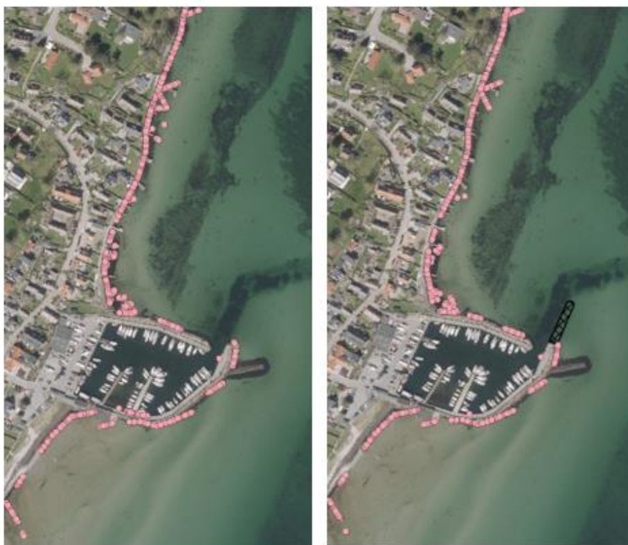
Figur 7.3.6: Case 2, Illustration af ålegræsaflejringen (lyserød cirkel) efter 30 dage med nord-østen vind.
