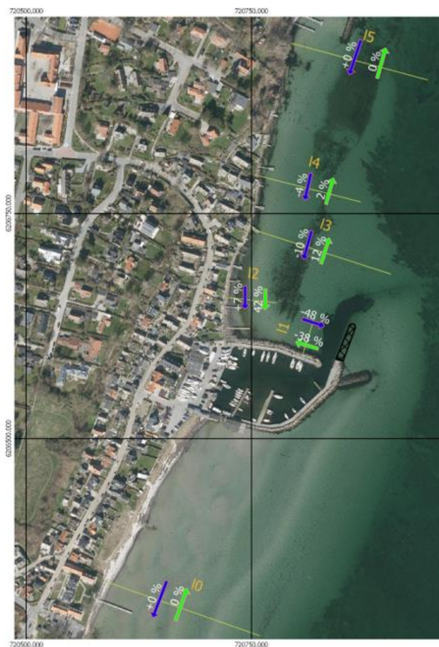
Figur 7.3.3: Relative ændring i sediment transportkapaciteten for bølger fra hhv. nord- og sydøst givet ved en signifikant bølgehøjde på 1,5m og en peak periode på 4,5 s.
