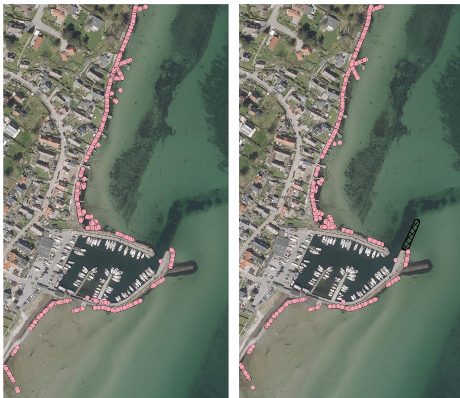
Figur 2.9: Case 2, Illustration af ålegræsaflejringen (lyserød cirkel) efter 30 dage med nord-østen vind.
